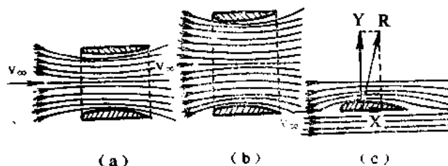
图 2-28 翼剖面产生空气动力
