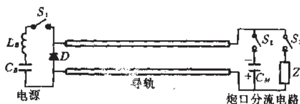
图 2-32 炮口分流电路的改进
