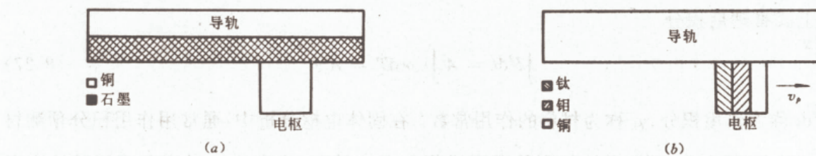
图 8-11 使电流分布趋向均匀的结构
